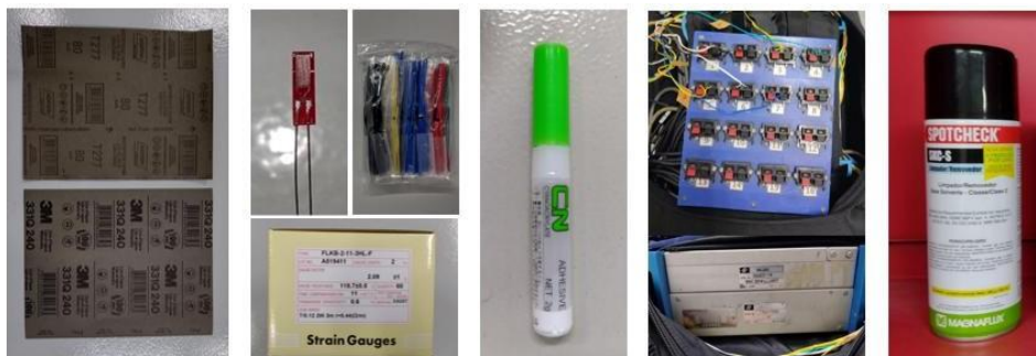
Figura 3 – (a) Lixas 80 e 240; (b) Extensômetros (Strain Gauges); (c) Adesivo cianoacrilatos; (d) Equipamento de dados (SR- 200); (f) Limpador (SKC-S).
