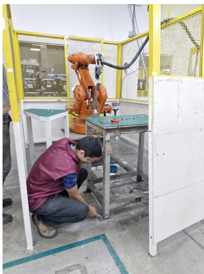
Figura 15 – Desmontagem da fixação do robô.
