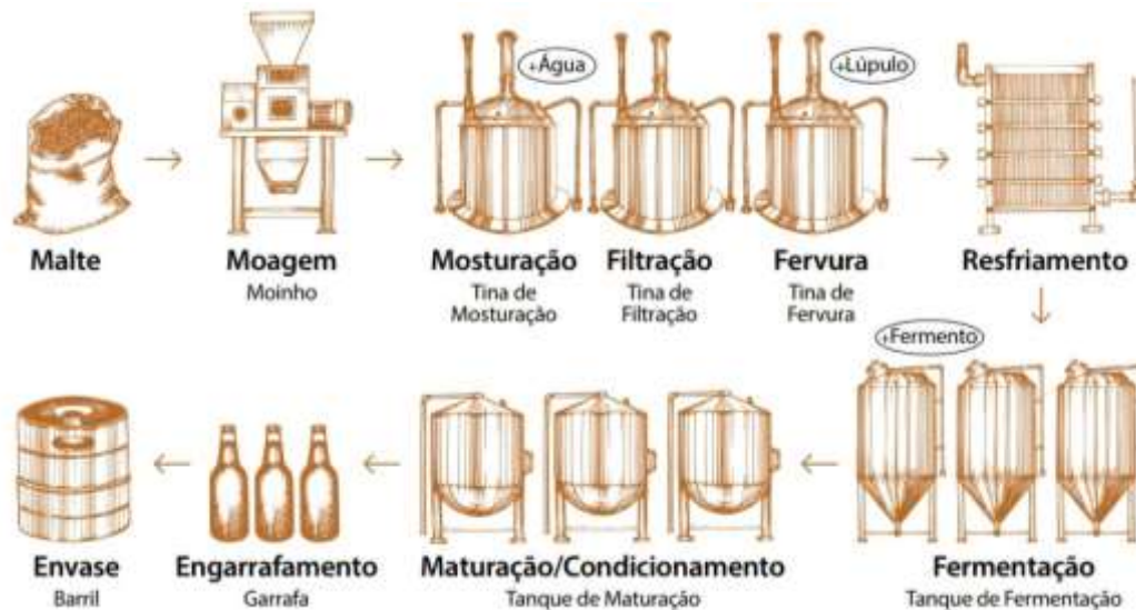
Figura 4 – Etapas do processo de produção cervejeira.
