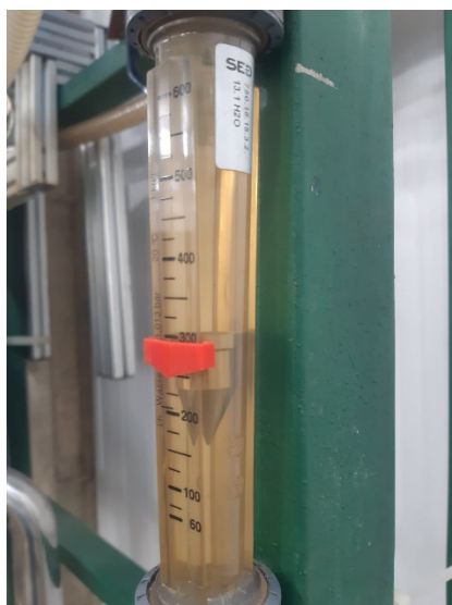
Figura 24: Rotâmetro do Fluido Frio a 300 L/h
