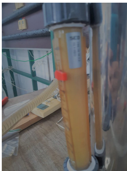
Figura 23: Rotâmetro do Fluido Quente a 500 L/h
