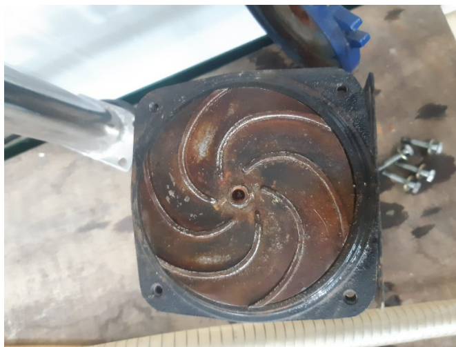
Figura 21: Bomba Centrífuga após a limpeza
