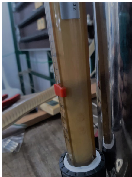
Figura 22: Rotâmetro do Fluido Quente marcando 300 L/h
