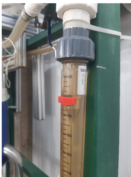
Figura 25: Rotâmetro do Fluido Frio a 500 L/h
