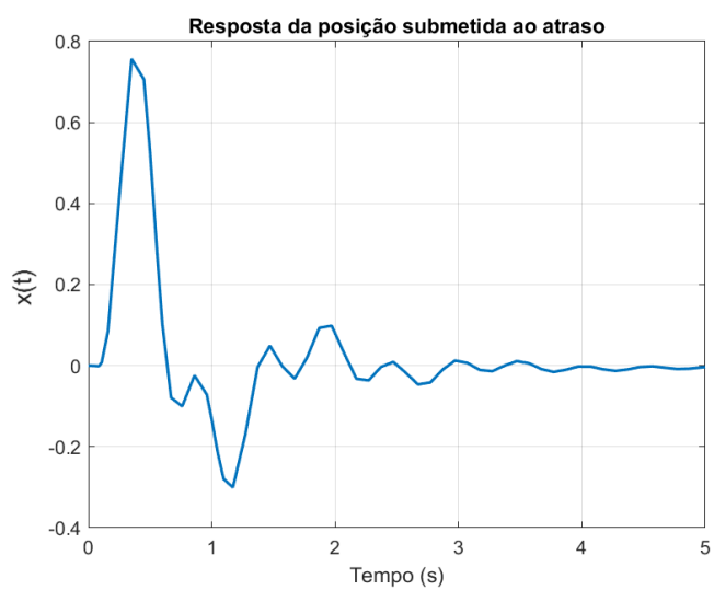
Figura 26 – Resposta do LQR com atraso de transporte para x .
