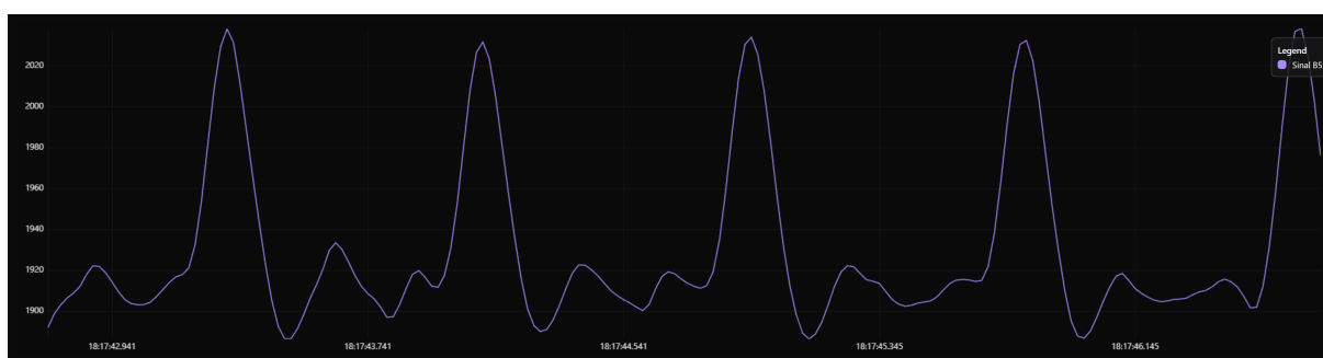
Figura 18 – Sinal com filtro Butterworth para 5 Hz.
