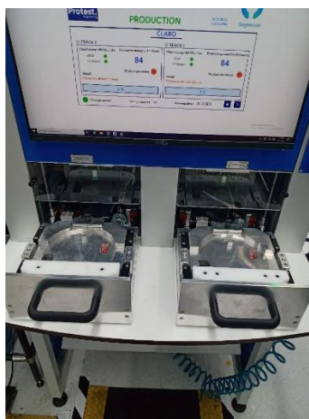
Figura 5 – Prensa pneumática responsável pela fixação do cabo flex no Top Cover
