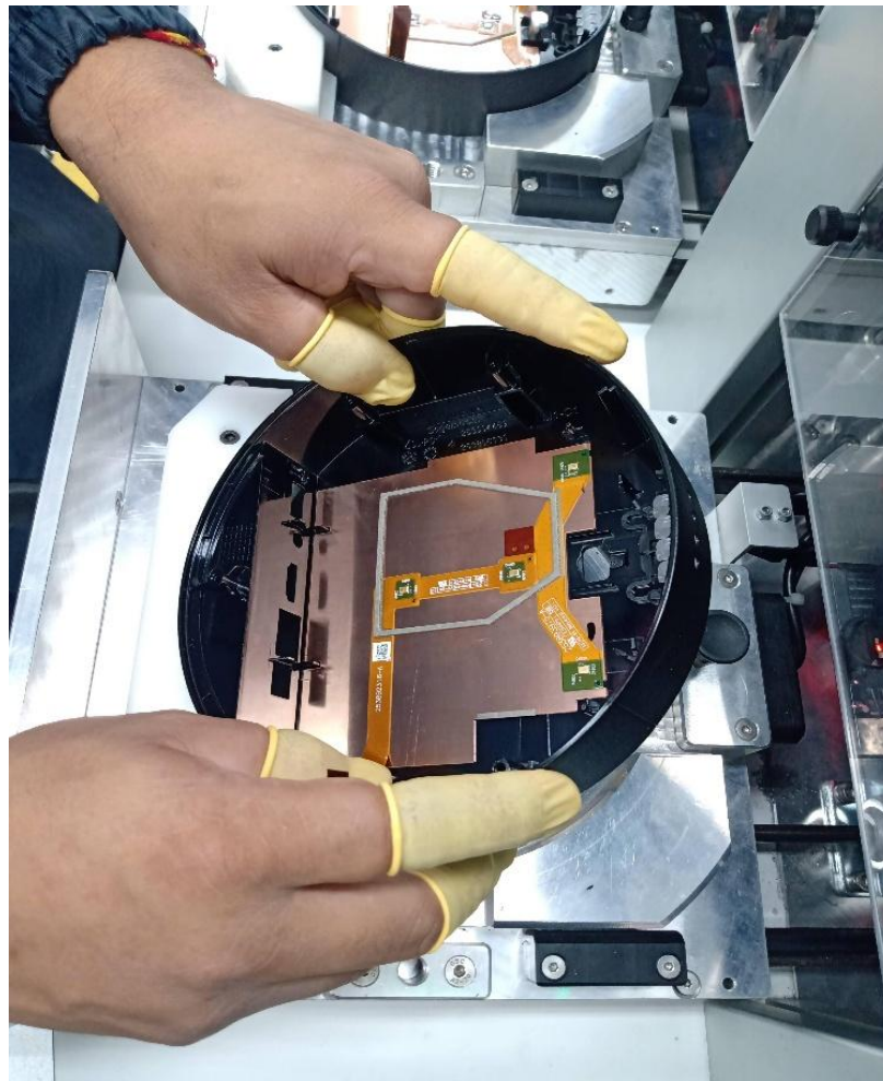
Figura 23 – Teste de prensagem do cabo flex no Top Cover com foams já montados
