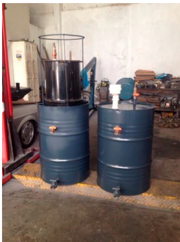
Figura 19 - Tambor da esquerda: reservatório de gás e o da direita câmara de fermentação
