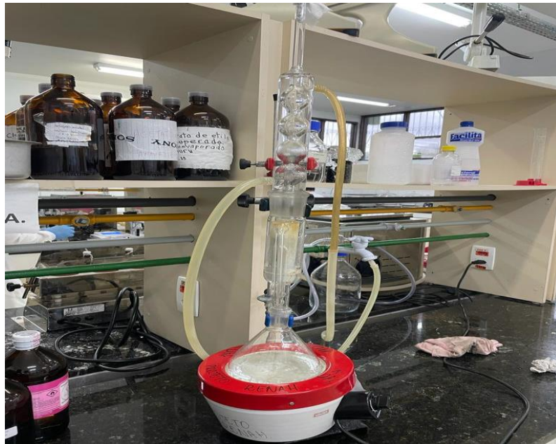
Figura 13 – Processo de extração de lipídios em Soxhlet
