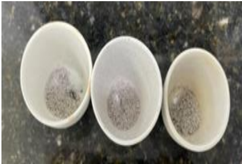
Figura 20 – Amostras com a quantidades de cinzas presentes na amostra do caroço de açaí.
