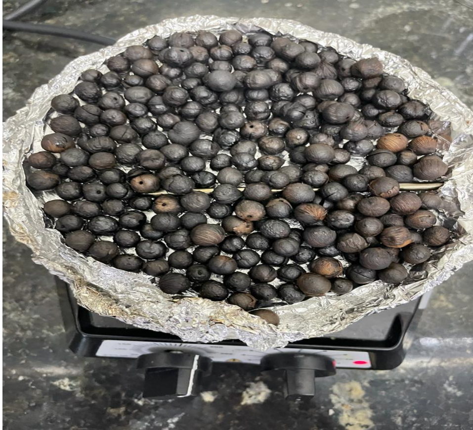
Figura 16 – Caroços de açaí após o processo de torrefação a 270°C durante 1 hora.
