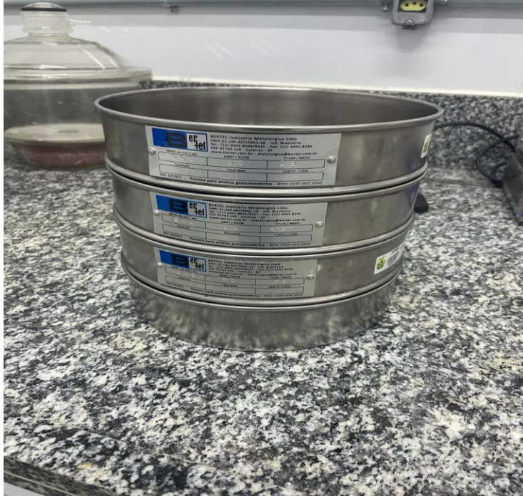
Figura 12 – Peneiras granulométricas utilizadas na determinação dos tamanhos das partículas dos caroços de açaí torrados e moídos.
