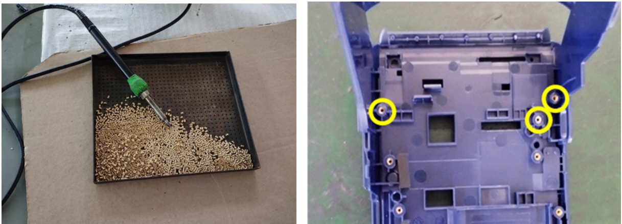
Figura 3 - Bancada para cravamento manual de insertos
