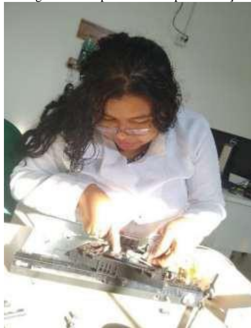
Figura 12: Desmontagem de um aparelho DVD para obtenção da lente objetiva.
