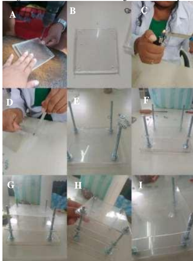
Figura 10: Procedimento de montagem do Movecópio.
