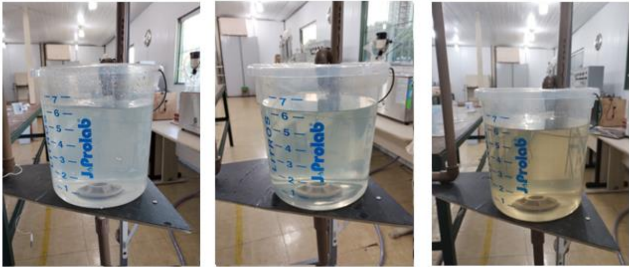
Figura 14 – Soluções experimentais antes e após o tratamento: (1) Solução inicial, (2) Solução final por fotólise direta, (3) Solução final por peroxidação fotoassistida
