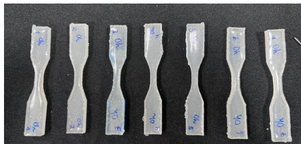
Figura 4 – Corpos de prova conforme a norma ASTM D638
