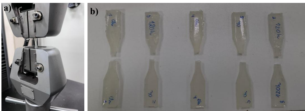
Figura 5 – a) ensaio de tração. b) corpos de prova tracionado.
