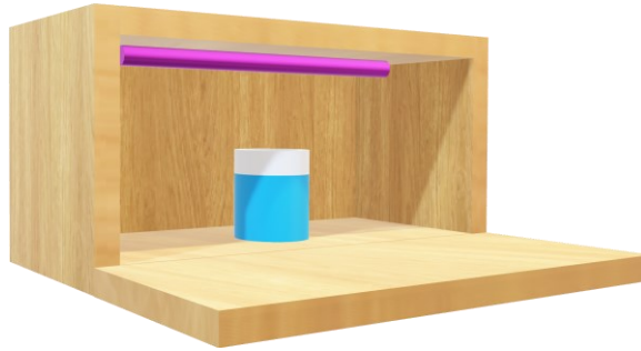
Figura 10 – Parte externa do reator fotocatalítico com destaque para: (A) Caixa de reação, (B) Trocador de calor
