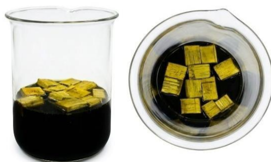
Figura 5: Amostras de madeira de marupá ( Simarouba amara ) embebidos em extrato aquoso de erva-de-passarinho ( Struthanthus spp ).
