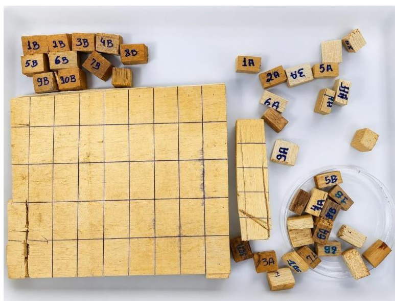
Figura 4: Confecção das amostras de madeira Simarouba amara (corpos de prova).
