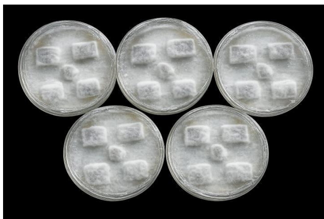
Figura 10: Aspecto das amostras de marupá após 120 dias de incubação.
