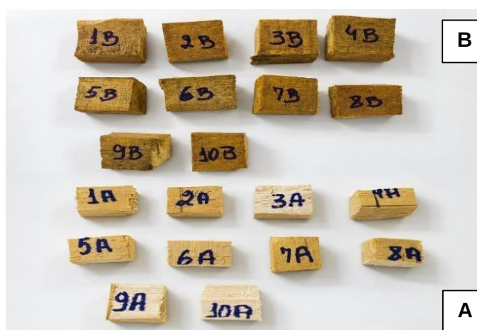
Figura 6: Aspecto das madeiras de marupá com extrato (B) e sem extrato (A).
