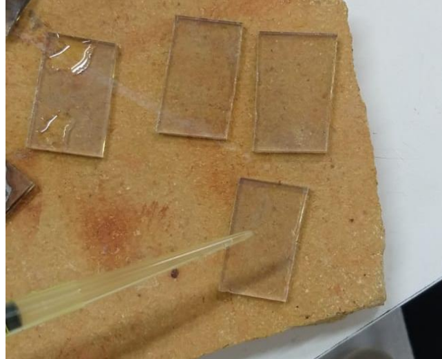
Figura 14 – Deposição de filme de platina sob substrato vidro/FTO
