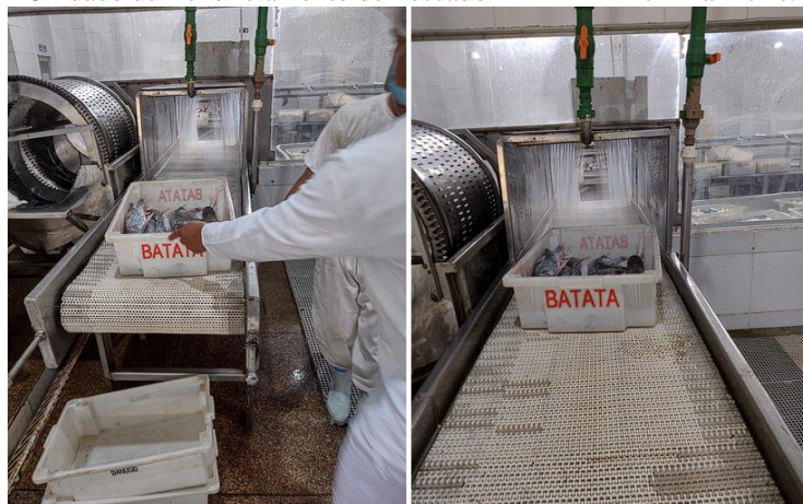
Figura 12: Higienização da matéria-prima através do cilindro de lavagem na área de Recepção/Lavagem pela Unidade de Beneficiamento de Pescado “Só Peixes” em Parintins.
