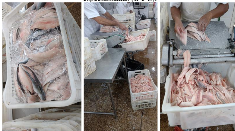
Figura 16: Pescado sendo resfriado após a evisceração (A). Retirada da pele do pescado através de máquinas especializadas (B e C).
