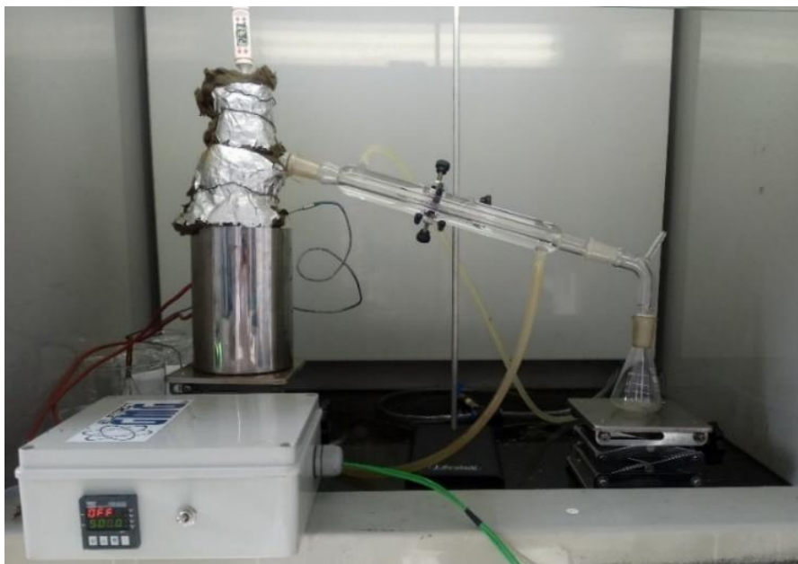
Figura 18 – Aparato Experimental para Pirólise em Escala de Bancada
