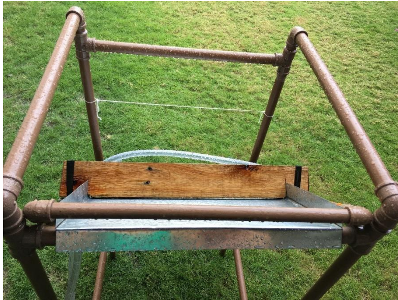
Figura 11 - Chapa de madeira utilizada para uniformizar o fluxo
