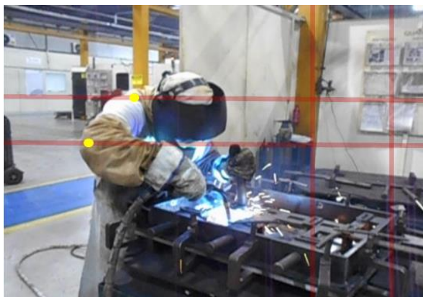
Figura 23 – Solda dos mancais
