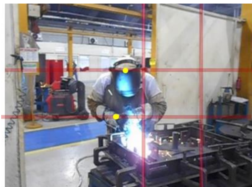
Figura 28 – Pontear com solda
