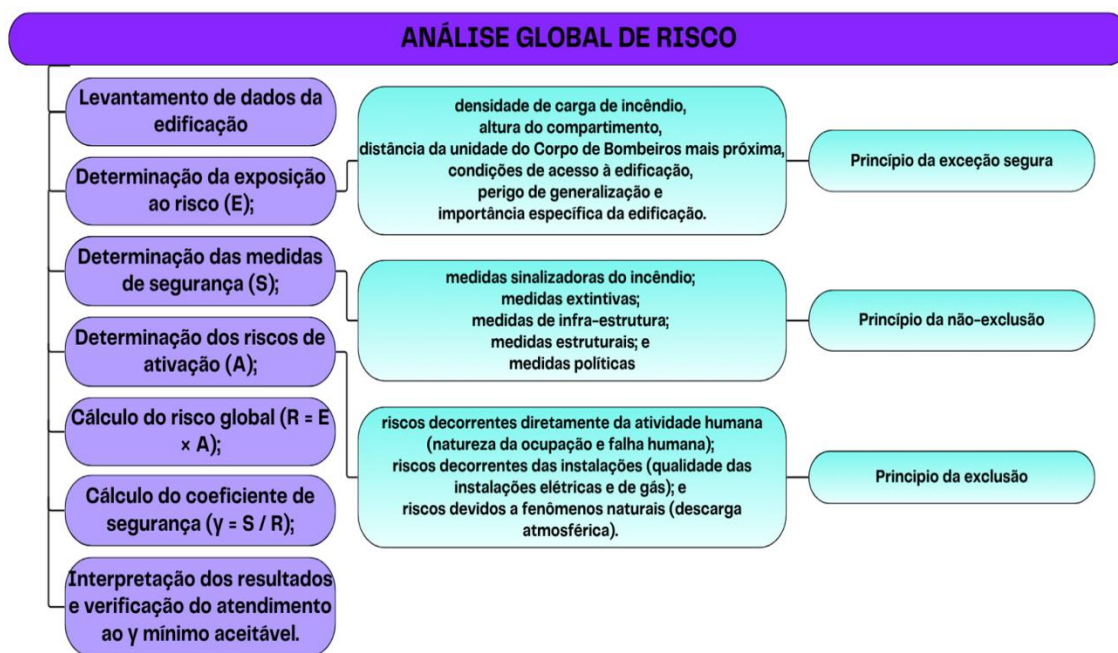
Figura 02 – Fluxograma da Metodologia adotada para análise global de risco
