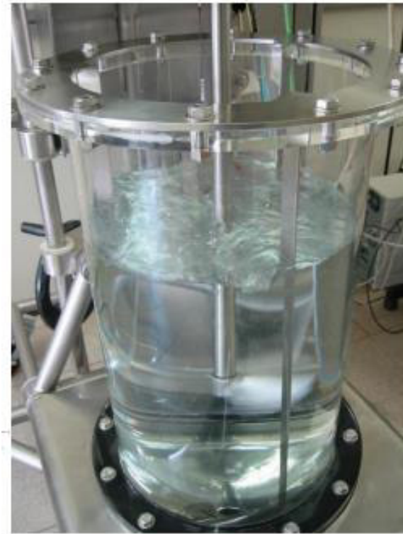
Figura 18 – Conjunto do tanque de agitação de 50 L.
