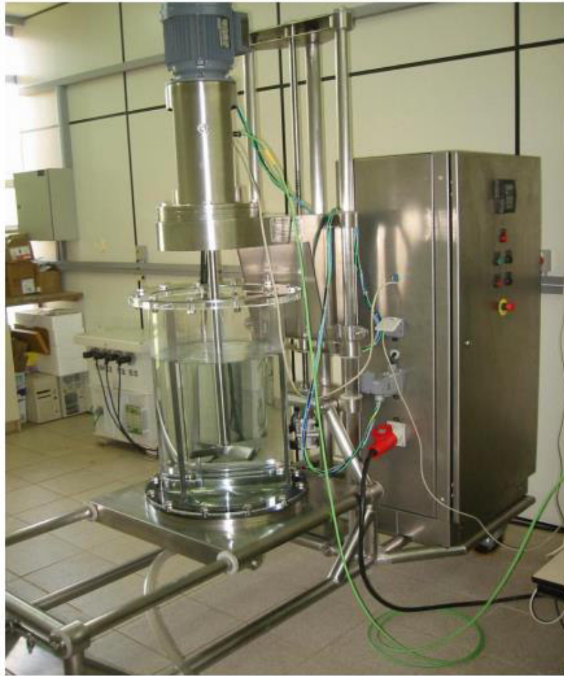
Figura 17 – Unidade piloto de agitação.
