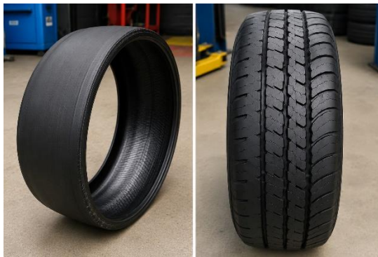
Figura 2 - Carcaça de pneu antes e depois da etapa passagem na prensa de vulcanização
