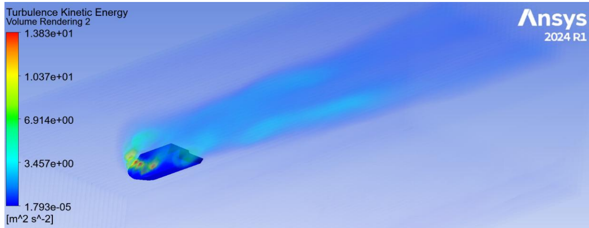
Figura 19. Energia cinética de turbulência (TKE – Turbulence Kinetic Energy ). (a) Vista em perspectiva. (b) Vista de perfil.
