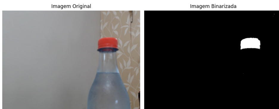
Figura 18 – Resultado da aplicação dos limiares para binarização do frame
