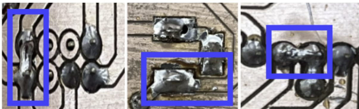
Figura 7 – Exemplo de curto-circuito entre trilhas
