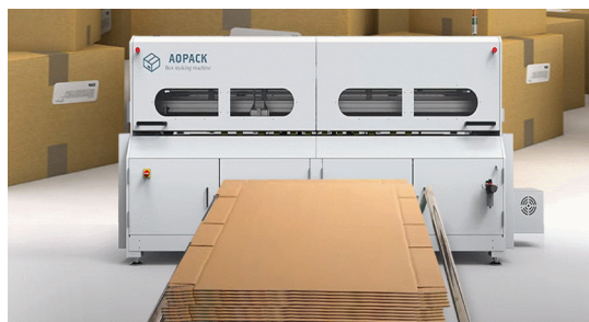
Figura 33. Máquina de corte industrial para confecção de caixas
