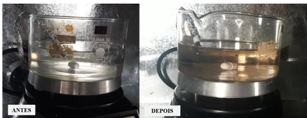
Figura 16 – Solução de paracetamol antes e após o tratamento por POA.
