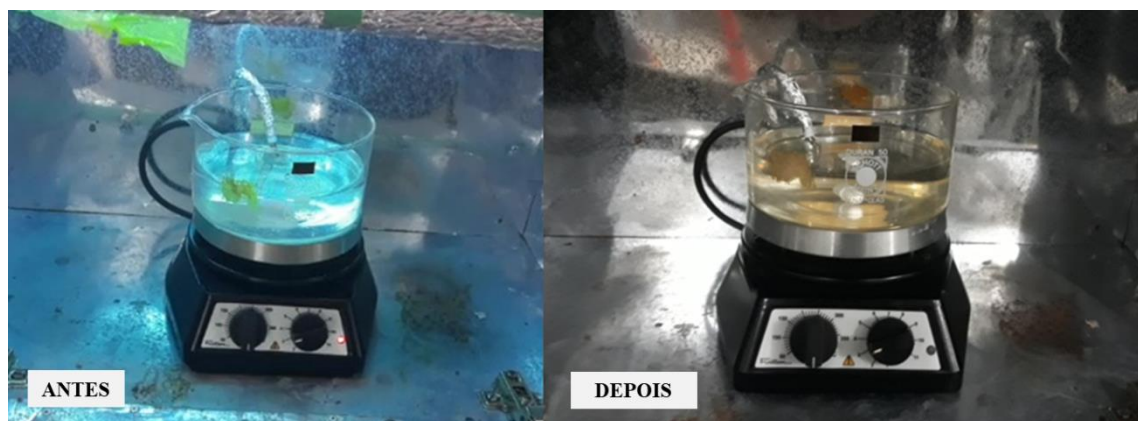
Figura 18 – Solução de atenolol antes e após ensaio de fotólise UV.
