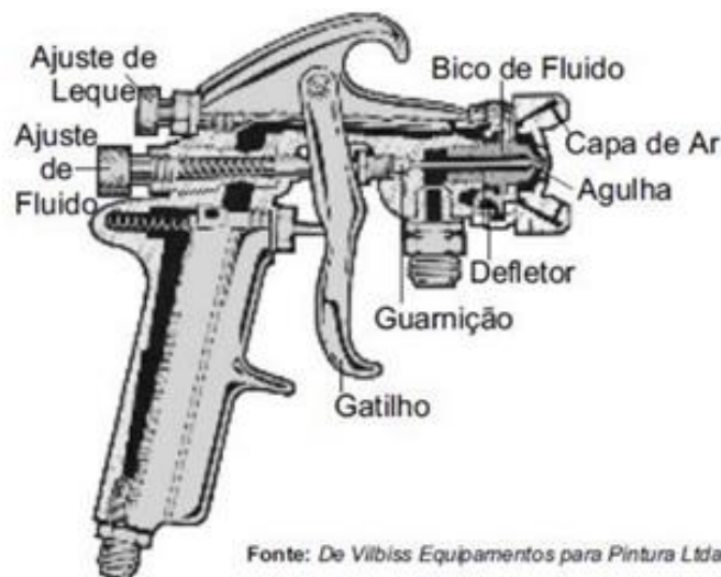
Figura 2 – Partes importantes de uma pistola convencional.
