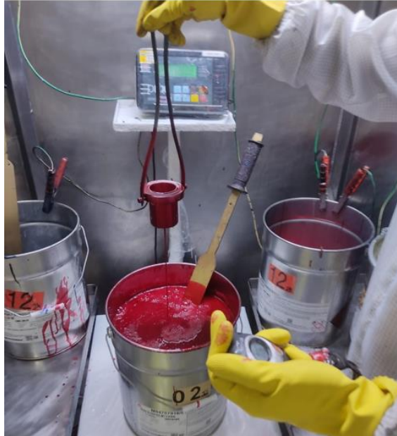
Figura 10 – Medição da viscosidade da tinta.
