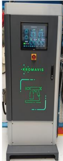
Figura 24 - Equipamento Kromavis, que utiliza nitrogênio para pulverização
