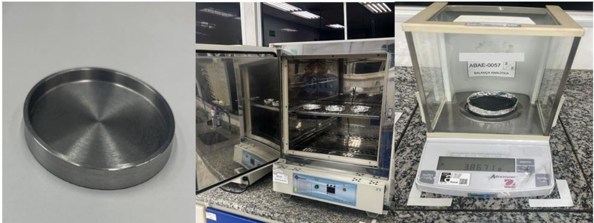
Figura 18 – Da esquerda para direita: Forma metálica, folhas de alumínio com tinta na estufa do laboratório e pesagem da folha com a tinta
