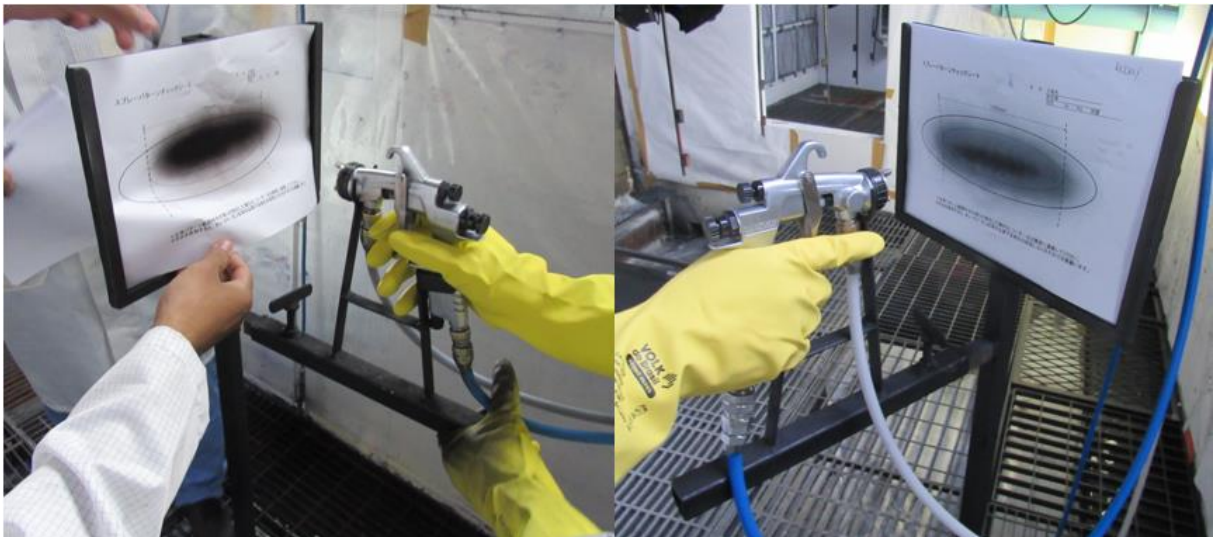
Figura 22 – Teste da abertura do leque da pistola
