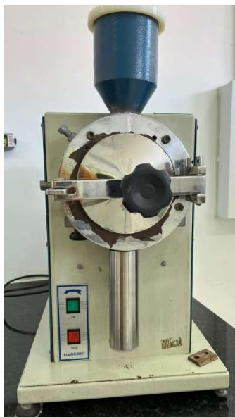
Figura 8 – Moinho de facas da marca Marconi.
