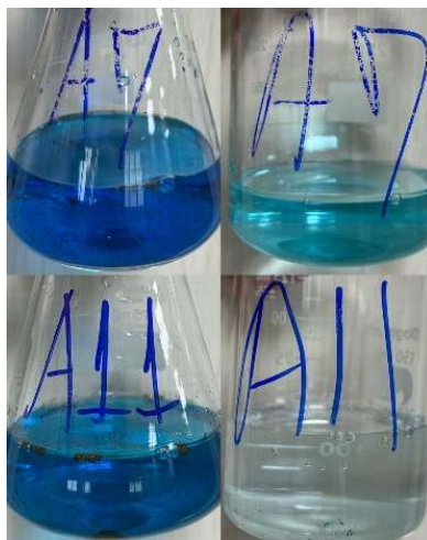
Figura 17 – Aspecto visual antes e após o ensaio de adsorção nos ensaios 7 e 11.
