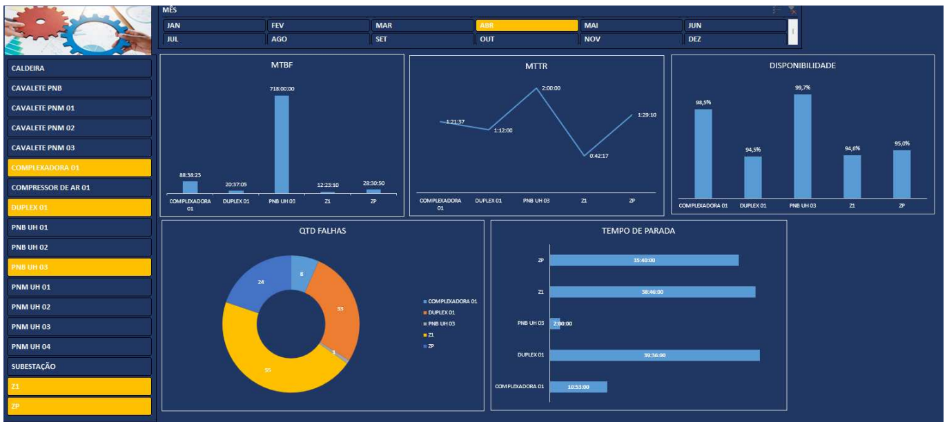
Figura 31. Dashboard no Excel com os indicadores de manutenção das máquinas críticas
