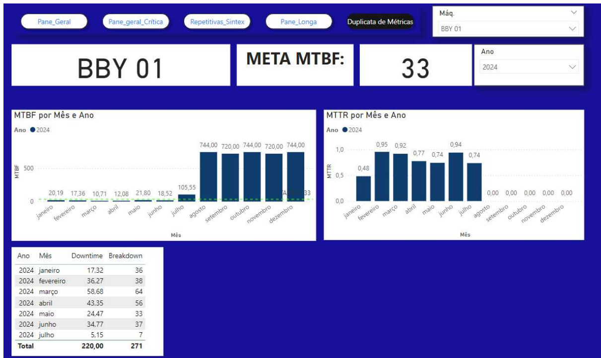
Figura 35. Consolidado de MTBF e MTTR de um ativo da Fábrica de pneus
