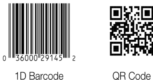
Figura 1: A diferença visual entre o código de barras de uma dimensão (1D) em inglês, 1D barcode e o QR Code (2D) bidimensional
