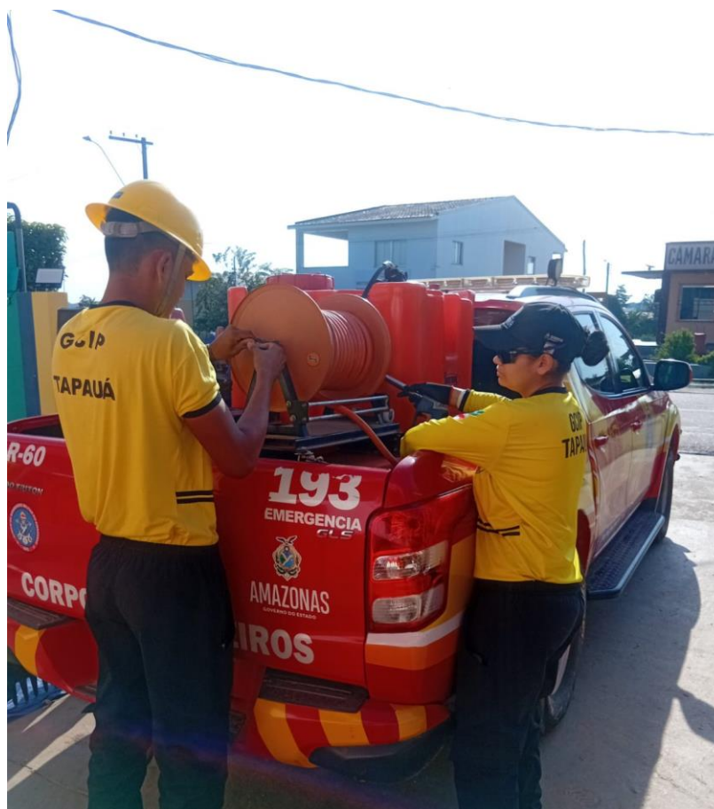
Figura 12: Viatura adaptada com kit pickup para combate a incêndios.
