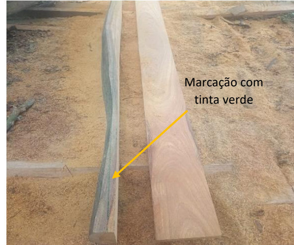
Figura 2 - Marcação das vigas
