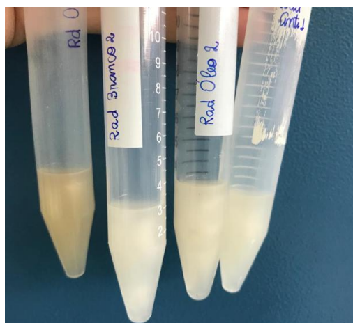
Figura 14 - Amostras de sabonete líquido submetidas ao teste de estresse térmico e ciclo gela-degela, após centrifugação.
