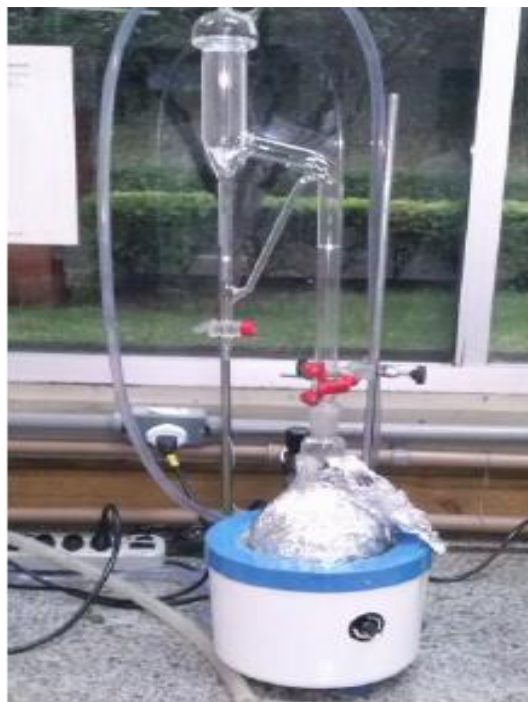
Figura 2 - Sistema Clevenger para extração de óleos essenciais.
