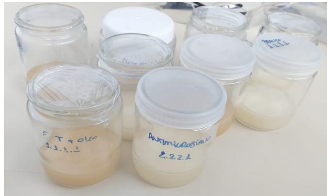
Figura 13 - Formulações após teste de ciclo gelo-degela.
