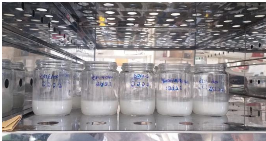
Figura 11 - Formulações de sabonete líquido após os testes de estresse térmico.
