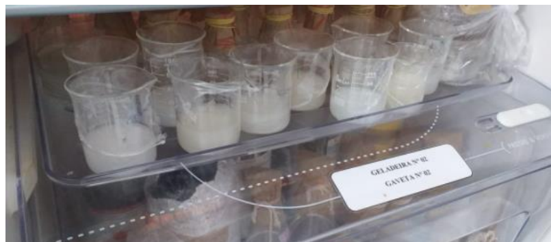
Figura 12 - Formulações de sabonete líquido em geladeira para teste de ciclo gelo-degela.
