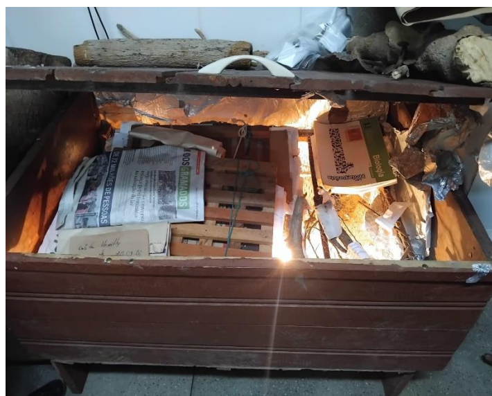
Figura 2 - estufa utilizada para secar os materiais coletados.
