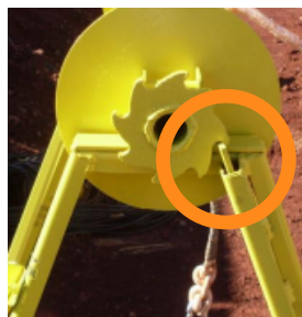
Foto: Dupla trava, localizada do lado esquerdo do sarilho.
