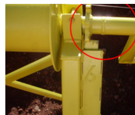
Foto: Vista frontal da lingueta de travamento.
