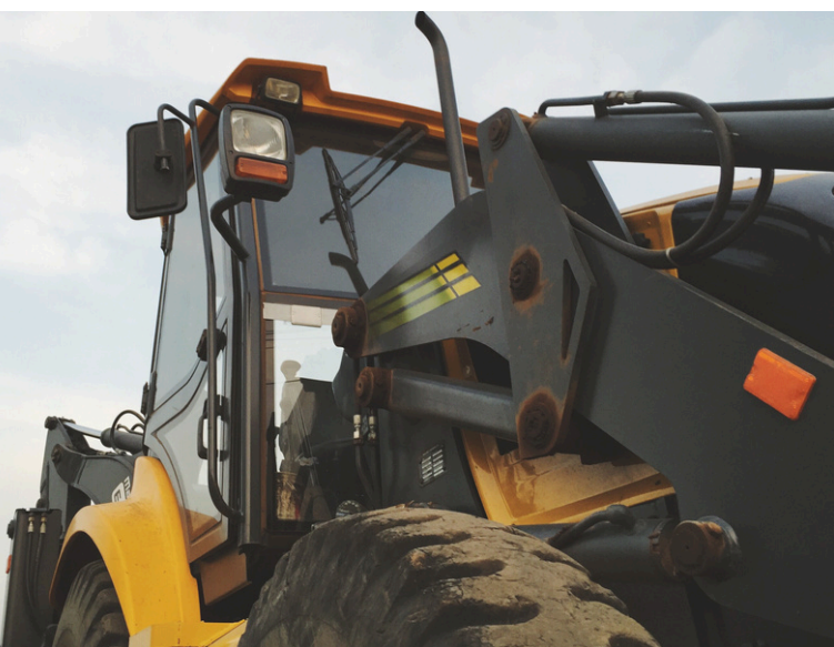
Foto: Posto de trabalho protegido contra queda e projeção de objetos e contra incidência de raios solares e intempéries.
