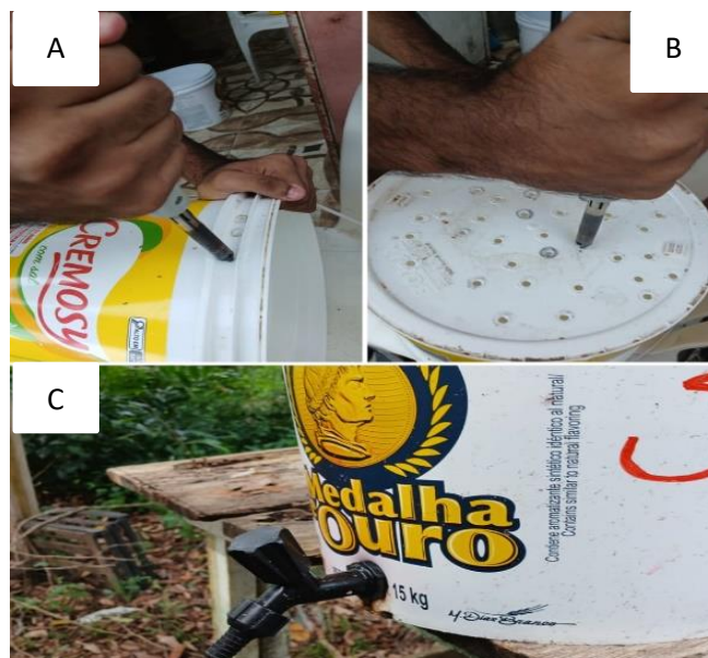
Figura 1: Perfuração dos baldes
