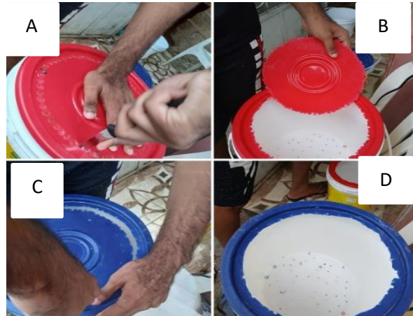
Figura 02: Corte das tampas dos baldes
