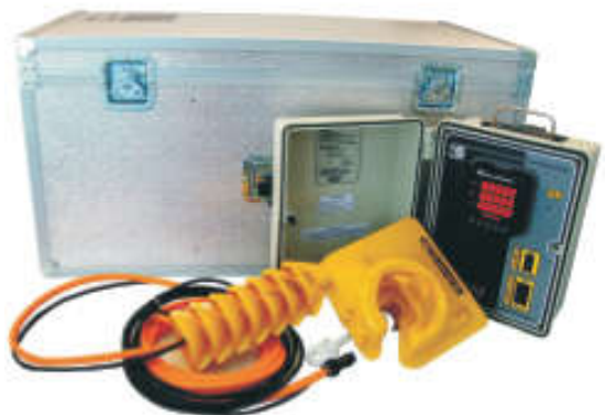
Figura 28- Analisador de Energia RM960PQ
