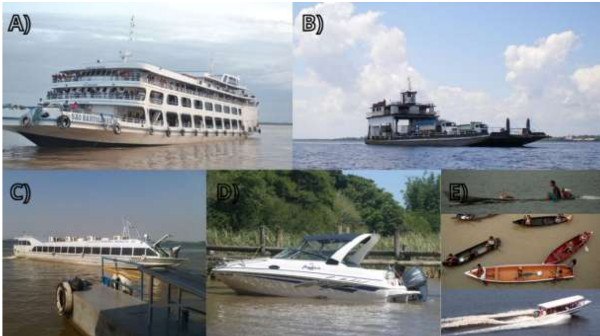
Figura 7– Tipos mais comuns de embarcações utilizadas no Amazonas: a) Recreio; b) Balsa; c) Expresso (“Ajato”); d) Lancha esportiva; e) Rabeta, canoa e voadeira. Fonte: (Portal Amazônia, 2022).
