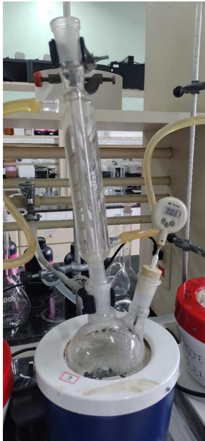
Figura 8 – Montagem da lixiviação.
