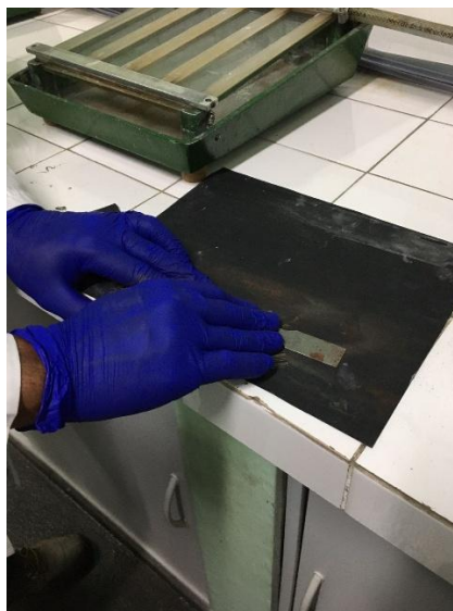
Figura 4 - Processo de Lixamento no laboratório de Engenharia de Materiais - UEA. Fonte: Autor, 2023.
