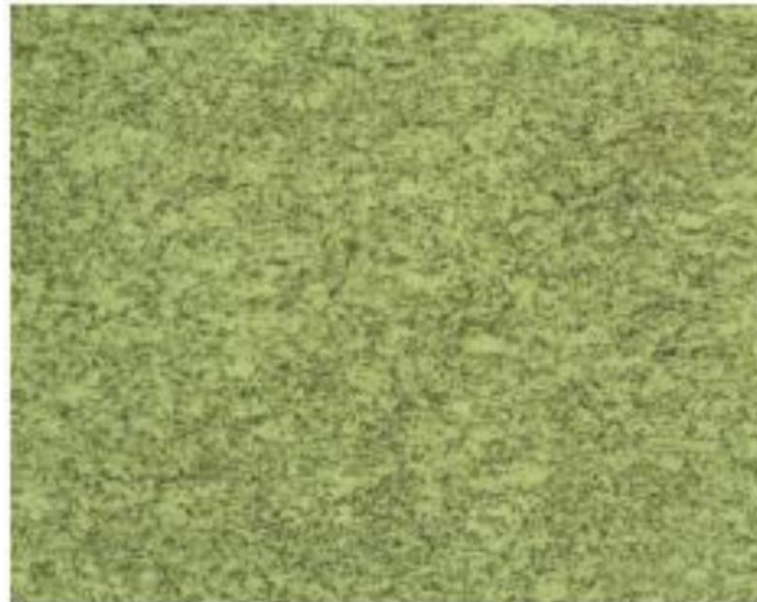
Figura 9 - Microestrutura corpo de prova com resfriamento a óleo, laboratório de Engenharia de Materiais da UEA. Fonte: Autor, 2023.
