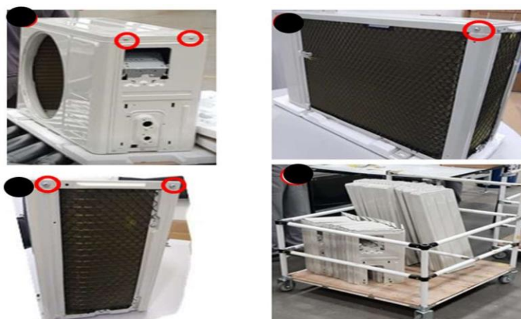
Figura 9 - Operação de desmontagem do mock-up da condensadora
