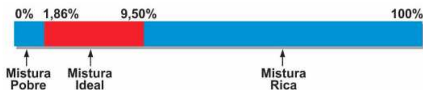
Figura 2 – Proporção Ar-GLP Necessária para a Ocorrência de Fogo.
