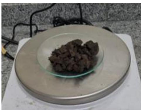
Figura 17- Amostras de lodo após ter ficado a 105°C na estufa.
