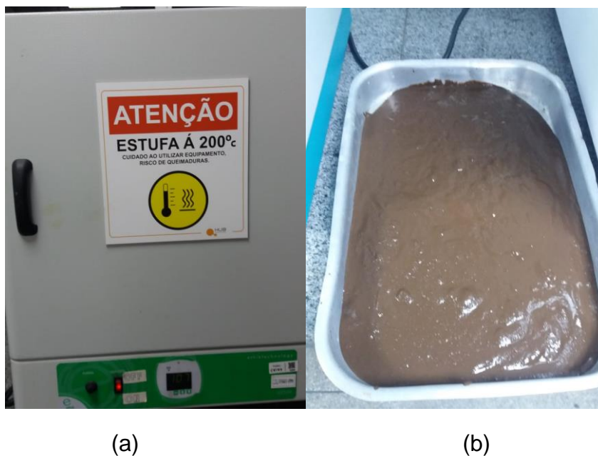
Figura 16- Estufa utilizada (a) e (b) amostra de lodo condicionada em uma forma
