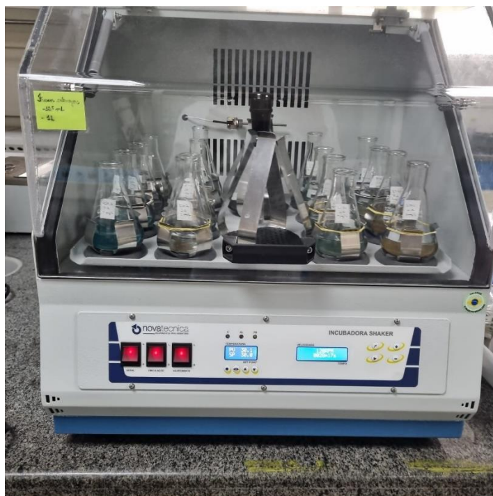
Figura 20- Ensaio de adsorção em batelada.
