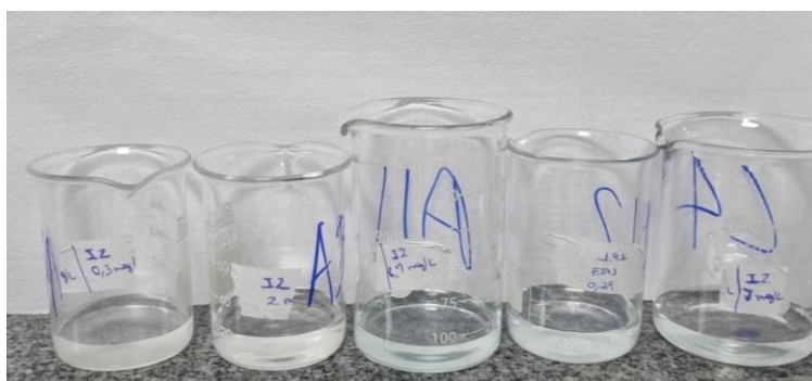
Figura 26- Soluções do corante azul de metileno depois da adsorção.
