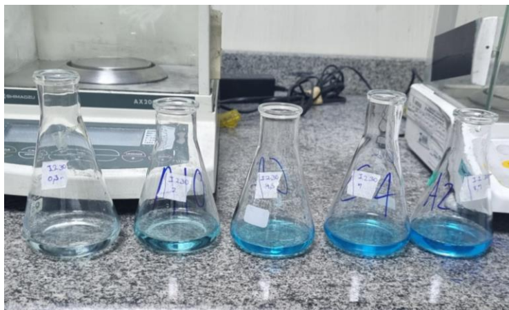
Figura 25- Soluções do corante azul de metileno antes da adsorção.
