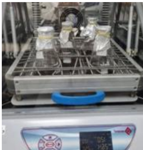
Figura 18- Amostras de lodo ativadas sob agitação na incubadora.
