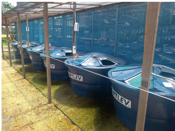
Figura 3 - Sistema de recebimento de peixes - caixas d'água de 1.000 L (10 unidades)
