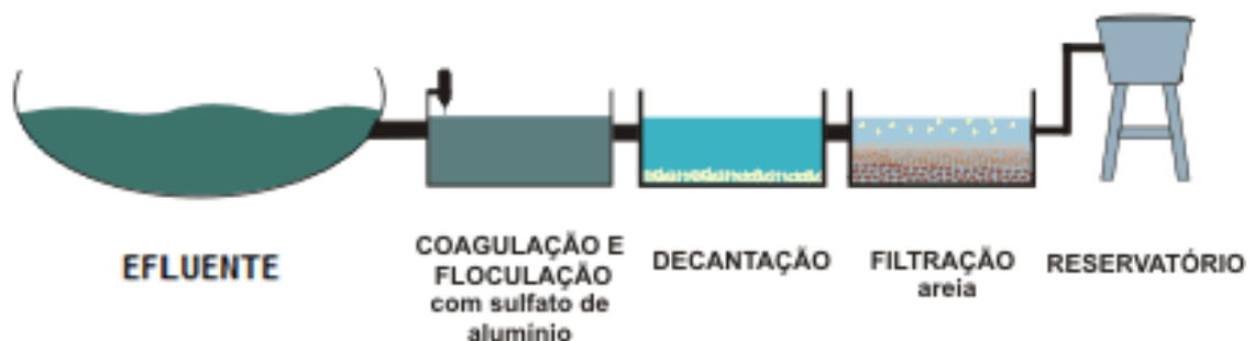
Figura 2 - Etapas do tratamento físico-químico de efluentes.
