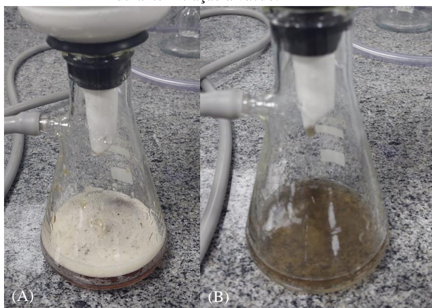
Figura 26: Solução via carbonização por mufla (A) e via reator hidrotermal (B) durante filtração à vácuo.
