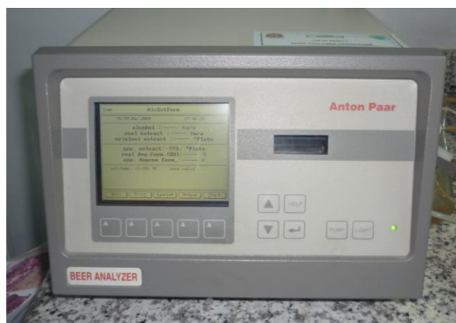
Figura 16. Aparelho Beer Analyser, utilizado para determinação do teor de extrato original e aparente, fermentabilidade e teor alcoólico da cerveja.
