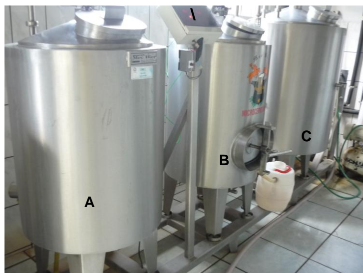
Figura 13. Tina de mostura (A), tina filtro (B) e cozinhador de mosto (C).
