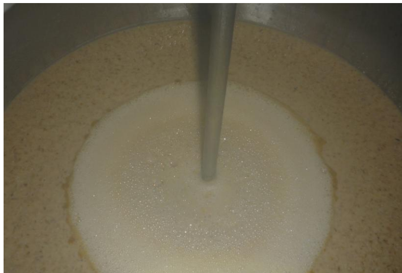
Figura 21. Processo de mosturação com adjunto de farinha de pupunha, mostrando sólidos em suspensão que originaram o bagaço. Na figura o bagaço (pontos escuros) se diferencia do mosto pela sua coloração mais escura. Na parte central encontra-se a espuma formada durante a agitação do mosto.
