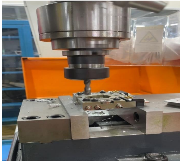
Figura 24 - Realização do processo de fresagem no lado fêmea do dispositivo
