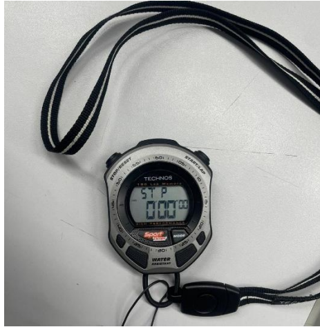
Figura 10 - Cronômetro Digital DC453/8P utilizado para medir os tempos
