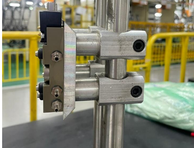
Figura 26 - Teste de fixação na garra após a fresagem
