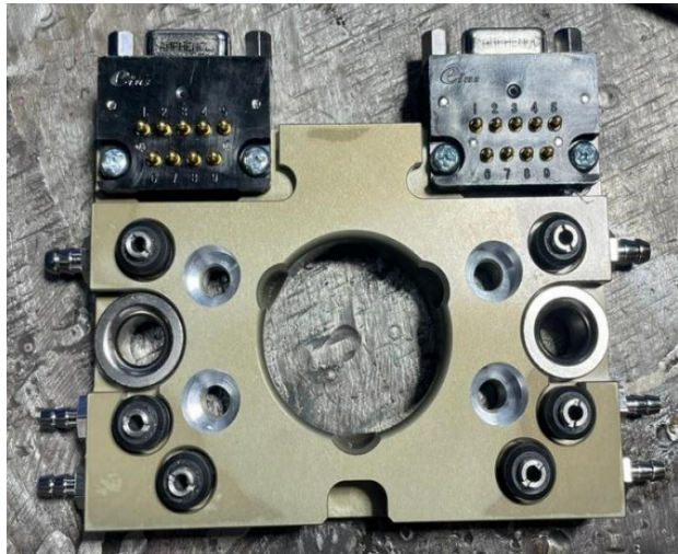
Figura 25 - Resultado do lado fêmea após o processo de fresagem
